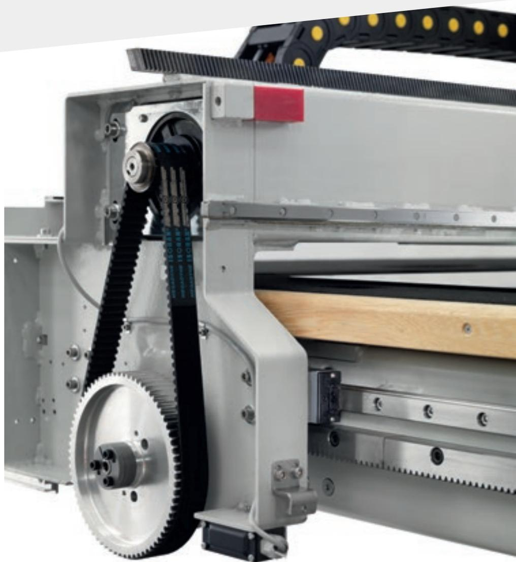
La manutention du pont de découpe a lieu avec un axe gantry motorisé et assure la plus grande précision et stabilité durant les façonnages.
