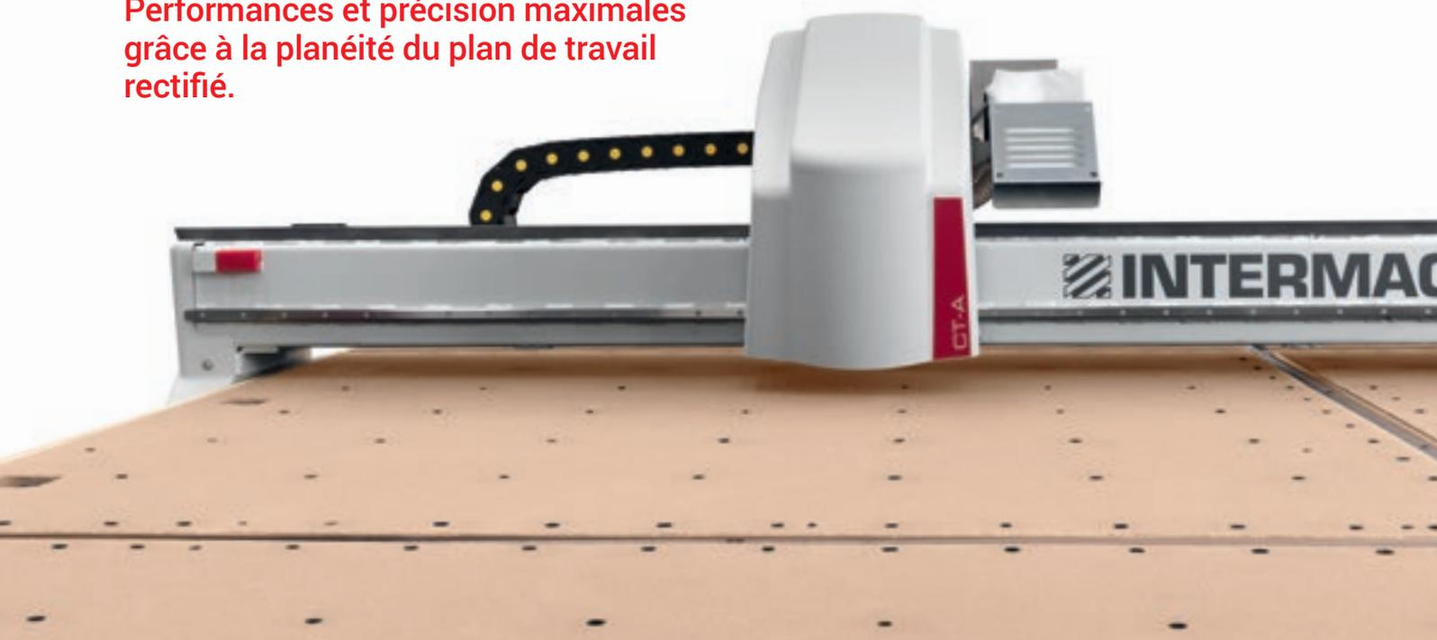
Le bâti de la machine est composé d'une structure rigide et rectifiée sur laquelle sont appliqués des panneaux en bois rectifiés qui assurent la plus grande planéité de la zone de façonnage ; une condition nécessaire pour la réussite optimale de l'incision et du rompage du verre.
