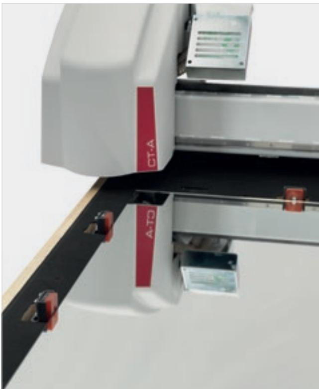
Les pieds automatiques servent d'appui pour le volume durant le basculement du plan, si nécessaire, de dispositifs d'alignement mécanique du volume.
